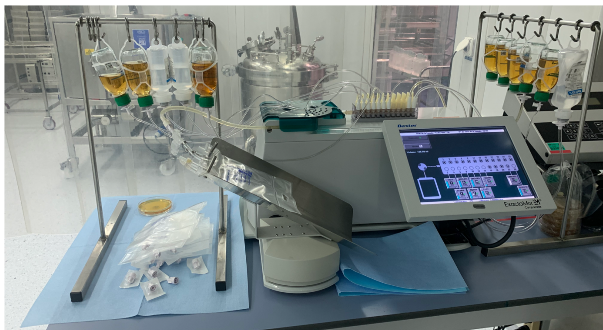
Figure 18: Montage de l'automate Baxter EM2400 sous le plafonnier de la salle 570.
