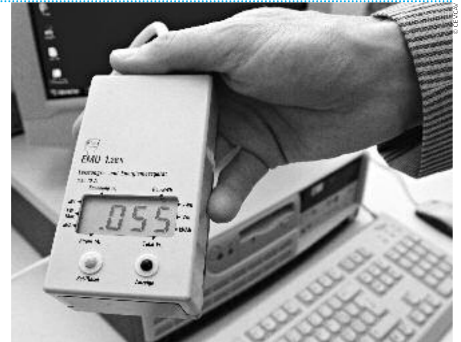
Appareil de mesure de consommation d'électricité connecté directement à la prise électrique de l'ordinateur.
