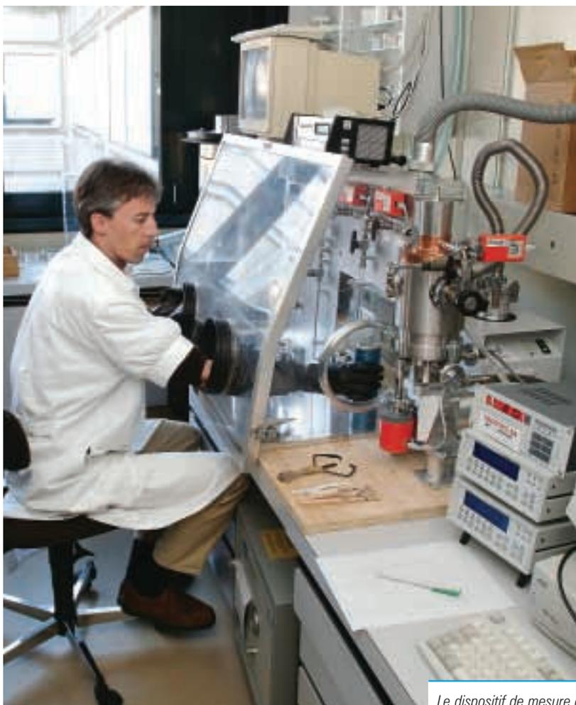
Le dispositif de mesure du radon.
