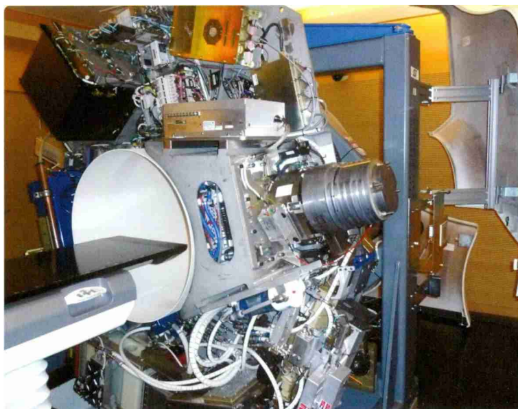
Mécanisme de l'appareil TomoTherapy. Au premier plan l'accélérateur de particules (source de radiations).
