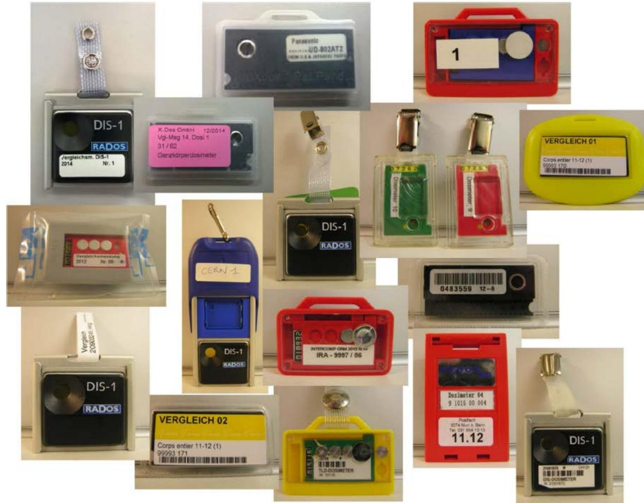
Figure 1 : Photographies des dosimètres reçus pour l'intercomparaison.
