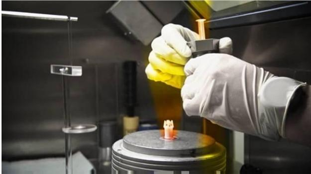
Fig. 14 : Prélèvement de l'activité à partir du récipient de stockage de fluor-18
