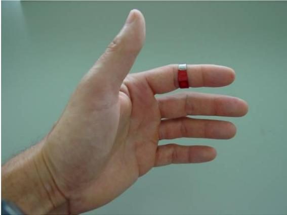
Fig. 1 : Port du dosimètre des doigts
