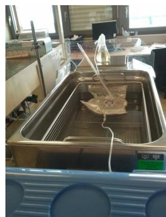
Figure F : Montage lors de la mesure du débit du perfuseur AutoSelector® à 13°C avec le régulateur de débit à 31°C
