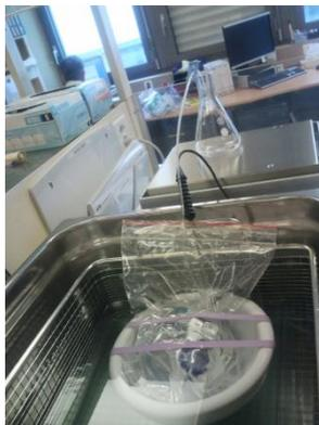
Figure 2 : Montage lors de la mesure du débit de la pompe à perfusion *AutoSelector*<sup>®</sup> à  $25^\circ\text{C}$
