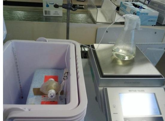
Figure H : Montage lors de la mesure du débit du perfuseur Easypump<sup>®</sup>1 à 13°C
