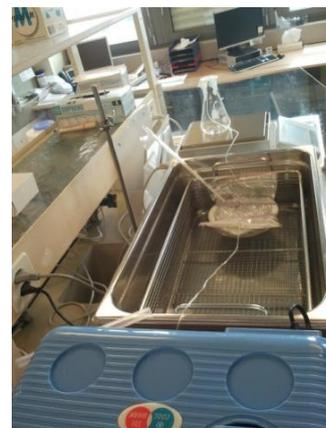
Figure L : Montage lors de la mesure du débit du perfuseur Easypump<sup>®</sup>1 à 13°C avec le régulateur de débit à 31°C
