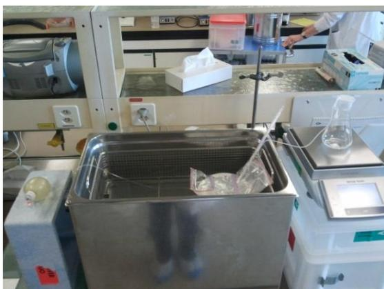
Figure K : Montage lors de la mesure du débit du perfuseur Easypump<sup>®</sup>1 à 22°C avec le régulateur de débit à 31°C
