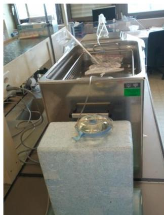
Figure E : Montage lors de la mesure du débit du perfuseur AutoSelector® à 22°C avec le régulateur de débit à 31°C
