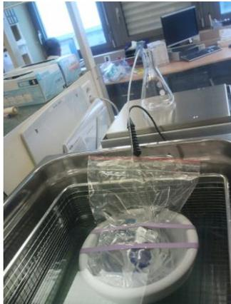
Figure A : Montage lors de la mesure du débit de la pompe à perfusion AutoSelector® à 25°C
