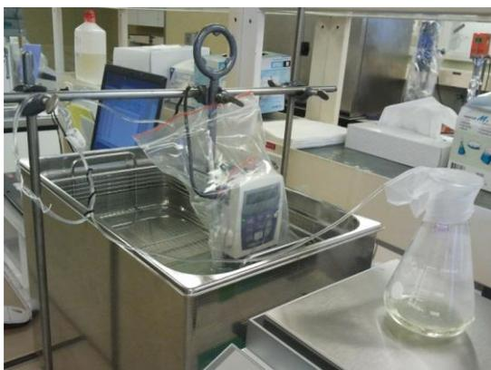
**Figure M : Montage lors de la mesure du débit du perfuseur CADD-Legacy<sup>®</sup> 1 à 25°**
