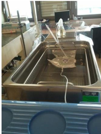
Figure 4 : Montage lors de la mesure du débit du perfuseur AutoSelector<sup>®</sup> à 13°C avec le régulateur de débit à 31°C
