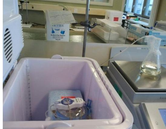
Figure B : Emplacement du perfuseur AutoSelector® dans le Frigo Box pour la mesure de débit à 13°C
