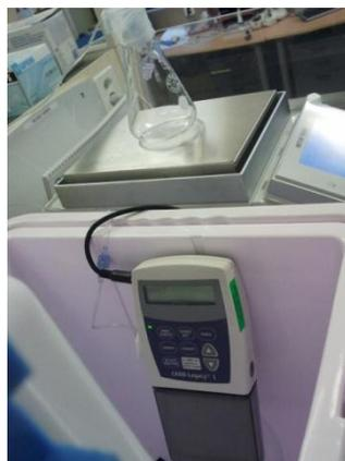
**Figure N : Montage lors de la mesure du débit du perfuseur CADD-Legacy<sup>®</sup> 1 à 13°**
