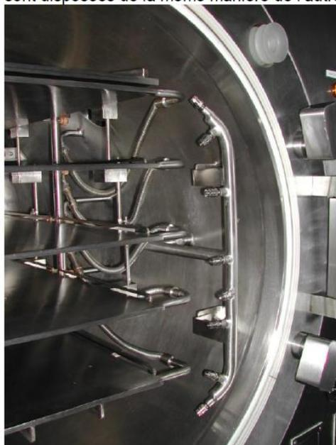
Figure 21 : disposition des buses
