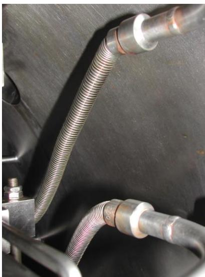
Figure 32: conduits à l'intérieur du lyophilisateur présentant un phénomène de corrosion
