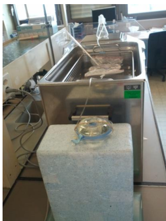
Figure E : Montage lors de la mesure du débit du perfuseur AutoSelector® à 22°C avec le régulateur de débit à 31°C
