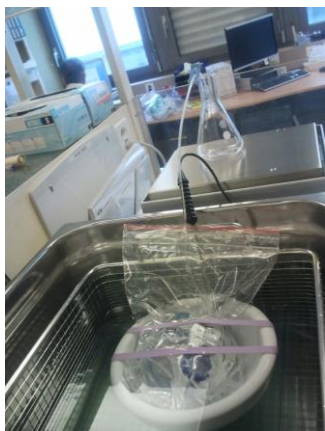
Figure A : Montage lors de la mesure du débit de la pompe à perfusion AutoSelector® à 25°C
