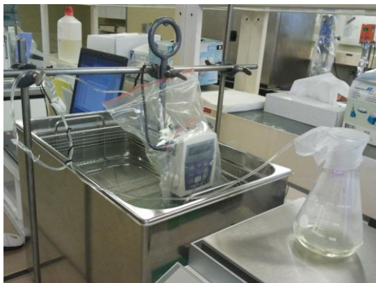
Figure M : Montage lors de la mesure du débit du perfuseur CADD-Legacy ® 1 à 25°
