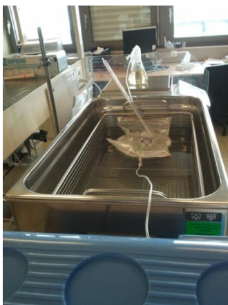
Figure 4 : Montage lors de la mesure du débit du perfuseur AutoSelector® à 13°C avec le régulateur de débit à 31°C
