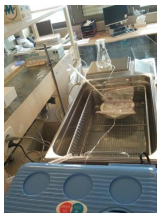
Figure L : Montage lors de la mesure du débit du perfuseur Easypump® 1 à 13°C avec le régulateur de débit à 31°C
