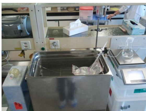
Figure K : Montage lors de la mesure du débit du perfuseur Easypump® 1 à 22°C avec le régulateur de débit à 31°C
