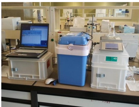
Figure C : Montage lors de la mesure du débit du perfuseur AutoSelector® à 13°C
