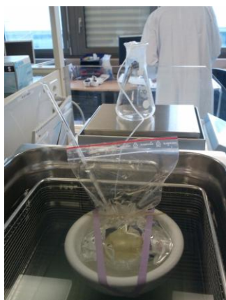
Figure G : Montage lors de la mesure du débit du perfuseur Easypump® 1 à 25°C
