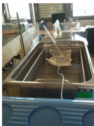
Figure F : Montage lors de la mesure du débit du perfuseur AutoSelector® à 13°C avec le régulateur de débit à 31°C
