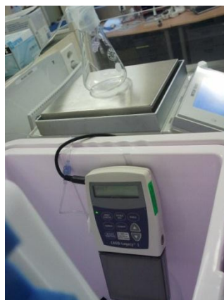
Figure N : Montage lors de la mesure du débit du perfuseur CADD-Legacy ® 1 à 13°
