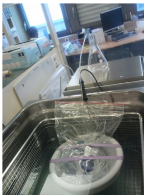
Figure 2 : Montage lors de la mesure du débit de la pompe à perfusion AutoSelector ® à 25^\circ\text{C}
