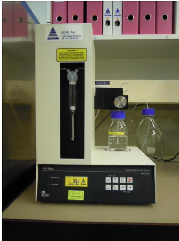
**Figure 22 : Compteur de particules Royco® utilisé dans ce travail**
