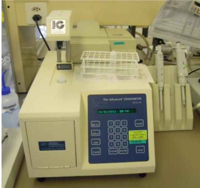
**Figure 21 : Osmomètre Advanced Instrument utilisé dans ce travail**
