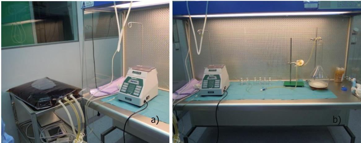
**Figure 31 : Remplissage des fioles sous flux laminaire en zone classée B :**
