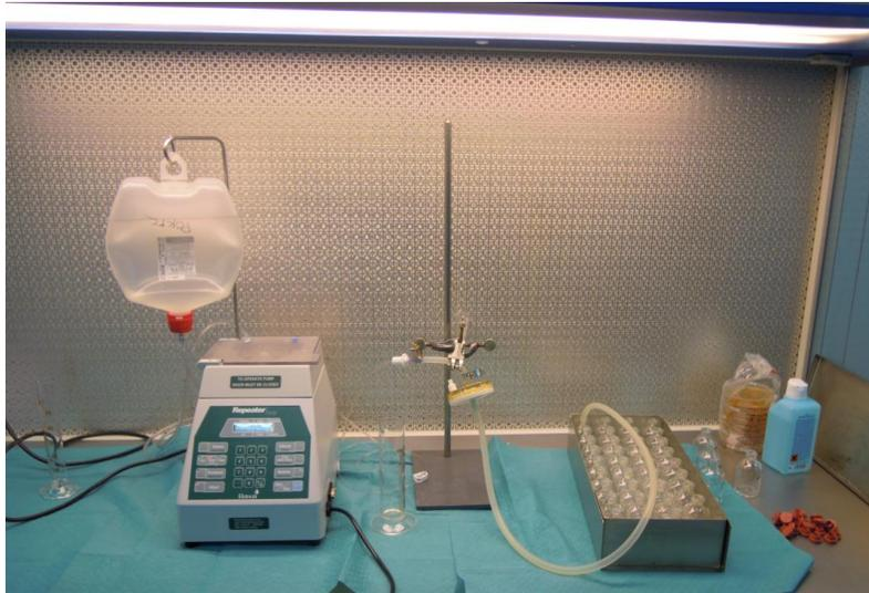
**Figure 28 : Remplissage des fioles d'amiodarone avec la pompe Repeater<sup>®</sup>**
