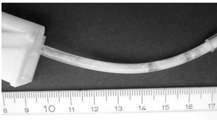
Figure 36 : exemple de précipité observé dans la tubulure d'un patient de soins intensifs (échelle en cm)
